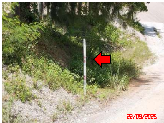
รูปที่ 21 หลักหมุดแสดงขอบเขตการทำเหมือง
